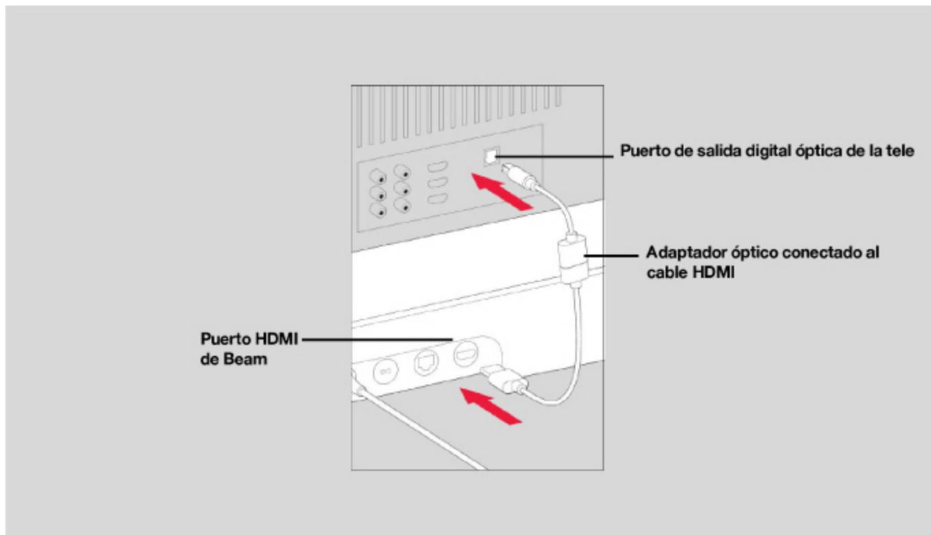
**Nota:** El puerto del adaptador óptico tiene forma de D. Asegúrate de que el conector está bien conectado en el puerto. Si insertas el adaptador de forma incorrecta, podrías estropear el cable.
