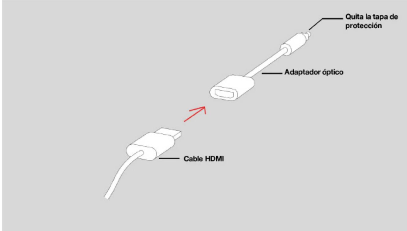
3. Conecta el adaptador óptico al puerto de **salida digital óptica** de la tele.
